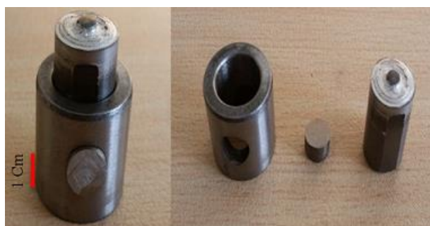
Fig. 4 Assembly and demounting of the friction welding tool شکل 4 مونتاژ و دهمونتاژ ابزار جوشکاری اصطکاکی اغتشاشی
